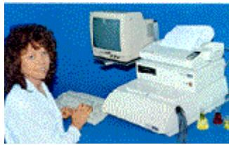
**1968** SAFAS présente le **tout premier test de dissolution de médicaments entièrement automatique**, son 210 DISS. Il était déjà proposé avec un portoir automatique pour 10 cuves, et permettait un enregistrement graphique simultané de 10 cinétiques de dissolution, et muni en standard de 8 cuves à circulation, d'un enregistreur graphique traçant les cinétiques des 8 bains de dissolution, avec des temps de cycles programmables.
